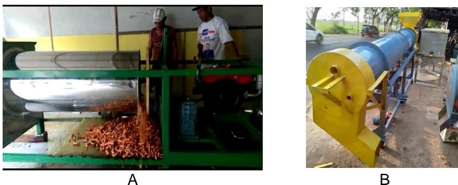
**Gambar 2. Mesin pencuci empon-empon dengan kapasitas 50 kg/pencucian (A) dan mesin pengering rotary dryer berbahan stainless steel menggunakan tenaga diesel 6HP dan kompor gas sebagai pemanas tabungnya (B)**
